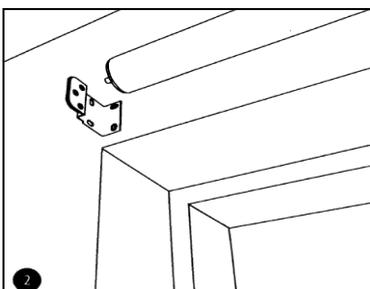
Führen Sie das zusammengesetzte Rollo zuerst auf der Seite der Walzenkapsel in die Halterung ein.
