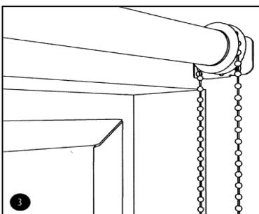
Setzen Sie anschließend die Getriebeseite von oben in das Getriebelager und fixieren Sie das Rollo durch Einsetzen des Interlocks.
