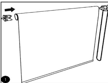
Stecken Sie Walzenkapsel und Getriebe seitlich in die Tuchwelle ein.
