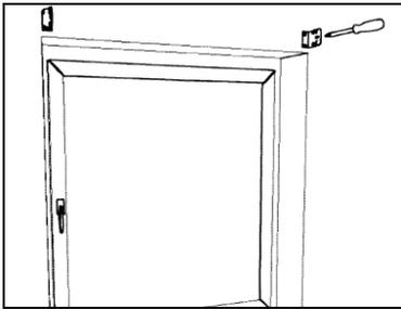
Schrauben Sie die Plastikhalterungen frontal auf das Mauerwerk.
